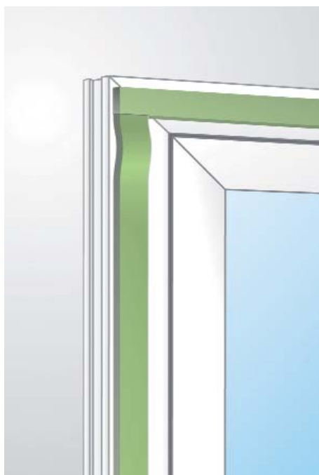
Realizzazione delle giunzioni angolari
