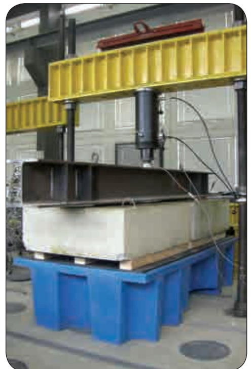
Auffangwanne PE-KT-EP5 unter einer Prüflast von 12.000 kg
