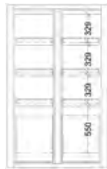
SIS Typ 90 / 1200 ES MI, Artikel-Nr. B80-2556-B, RAL 7035, inkl. 6 Auszugswannen (links) und 3 Auszugswannen sowie 1 Entsorgungsfach (rechts)
