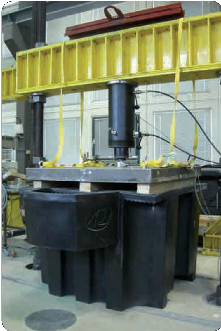
Auffangwanne PE-KT-EP6 unter einer Prüflast von 6.000 kg
