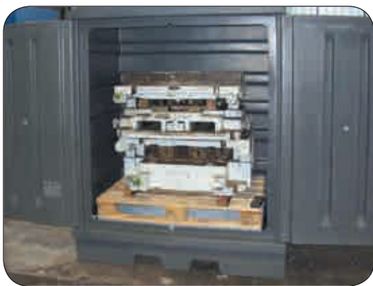
PE-200-EP8 unter einer Prüflast von 2400 kg
