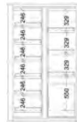
SIS Typ 90 / 1200 ES MI, Artikel-Nr. B80-2556-B, RAL 7035, inkl. 6 Auszugswannen (links) und 3 Auszugswannen sowie 1 Entsorgungsfach (rechts)
