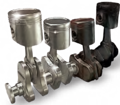
Beispielhafte Darstellung des Erscheinungsbildes beim Seq. VG Schlammtest für CASTROL GTX ULTRACLEAN (links) im Vergleich mit einem bestehenden SL-Öl (rechts)
