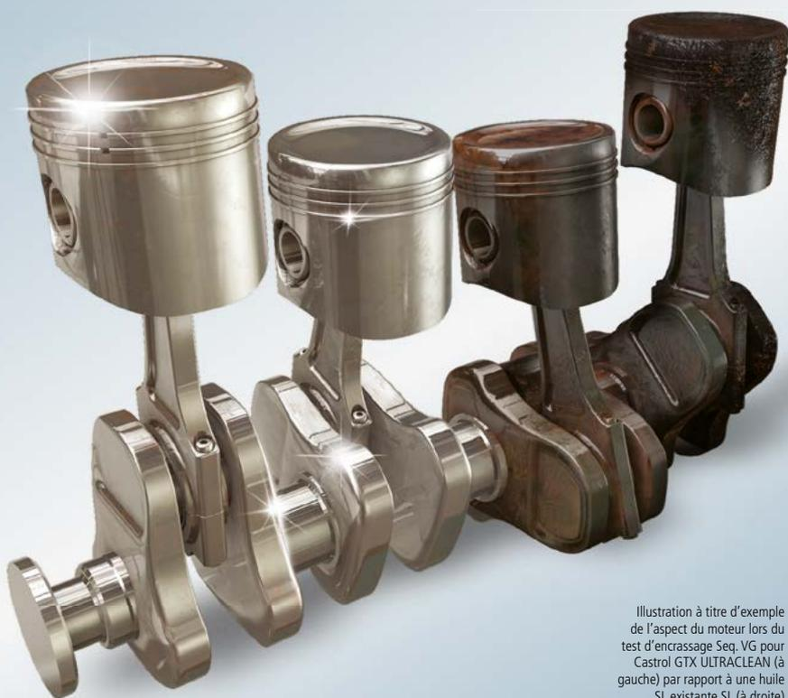
Illustration à titre d'exemple de l'aspect du moteur lors du test d'encrassement Seq. VG pour Castrol GTX ULTRACLEAN (à gauche) par rapport à une huile SL existante SL (à droite)
